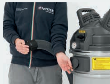
PullClean Filterabreinigungssystem: Einfach den Einlass des Saugers verschließen und mehrmals kurz die Nebenluftklappe betätigen.
